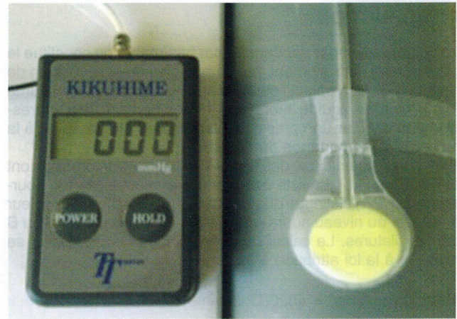
Figure 3. Boîtier à lecture digitale (Kikuhime ® ) raccordé à la pastille manométrique (3,2 × 4,0 × 0,3 cm de petit rayon, de grand rayon et d'épaisseur)(100 mm 2 ) dont la base est fixée sur un cylindre par du papier collant.
